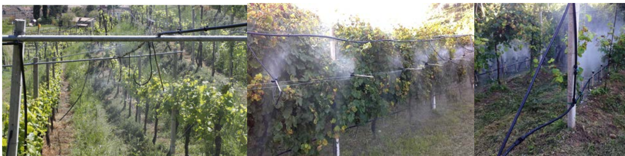
Figura 3. L'impianto fisso in funzione. Se gli ugelli sono ben orientati e liberi dalla vegetazione, la nebulizzazione ottenuta è simile a quella delle irroratrici e la bagnatura uniforme.
