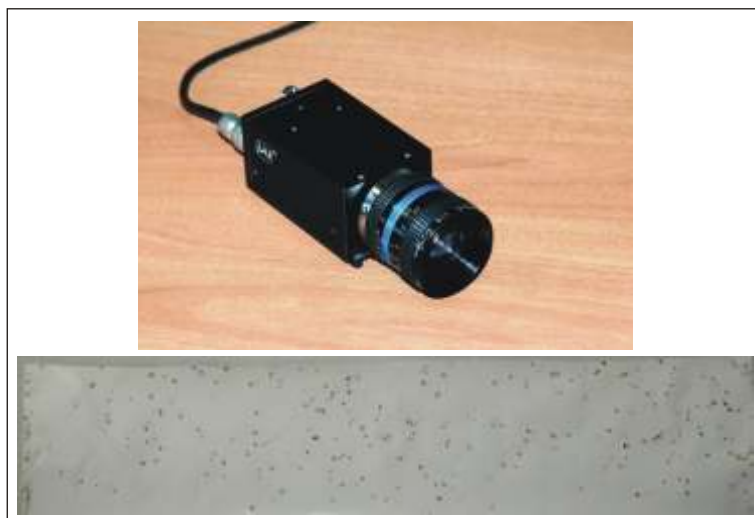
Fig. 5 Videocamera utilizzata per il controllo della distribuzione, mediante l'analisi dell'immagine dei granuli di vermiculite raccolti su carta adesiva. Sotto, particolare della banda adesiva (0,1 x 0,5 m)
