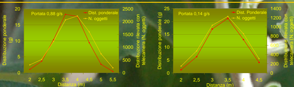
Fig. 4 Confronto delle curve di distribuzione del materiale disperso (vermiculite), ottenute con una misura ponderale e con valutazione del numero degli oggetti tramite analisi di immagine. Il diagramma mostra una localizzazione prevalente del prodotto fra i 2 e i 5 m dal punto di lancio. Il confronto fra i diagrammi di distribuzione ottenuti con le due metodologie di misura evidenzia la corrispondenza dei risultati ottenuti; ciò permette di ipotizzare per il futuro l'impiego del metodo di analisi d'immagine, che potrebbe consentire di eseguire i controlli anche su piani verticali o direttamente sulle colture.
