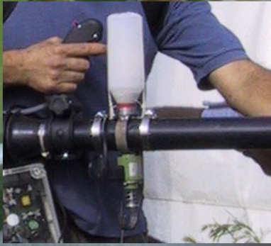
Fig. 1. Dispositivo per il dosaggio e distribuzione meccanica degli ausiliari in coltura protetta. Il flacone impiegato per la commercializzazione del materiale biologico viene inserito capovolto direttamente in un supporto entro cui opera un puntale metallico che, con movimento alternativo, penetra nel contenitore regolando il flusso di prodotto (materiale inerte e fitoseidi) che cade nel tubo di erogazione. Un elettromagnete consente di variare la frequenza di oscillazione del puntale e quindi la dose di prodotto da distribuire. La macchina dispone inoltre di un regolatore del regime motore che consente di modificare la portata dell'aria in mandata e quindi la distanza di erogazione.
